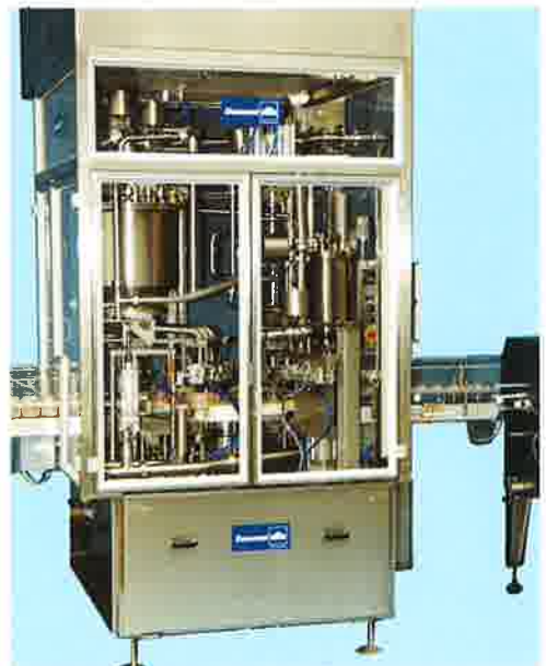
Reinluftkabine, keimarme Füllung
