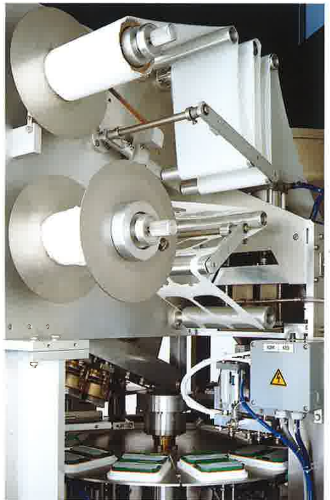
Integrierte Folienstanze für Kunststoff-Folien mit Siegelung und Stanzgitter-Aufwicklung
