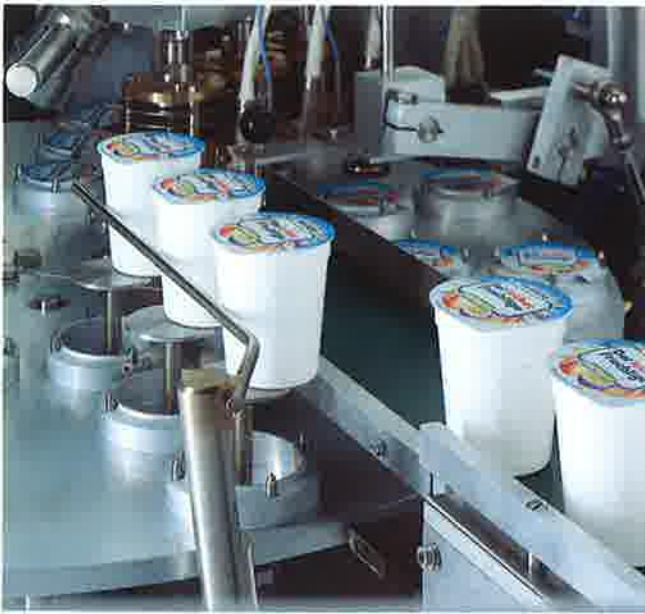
Becherausheben und Abtransport auf Förderband
