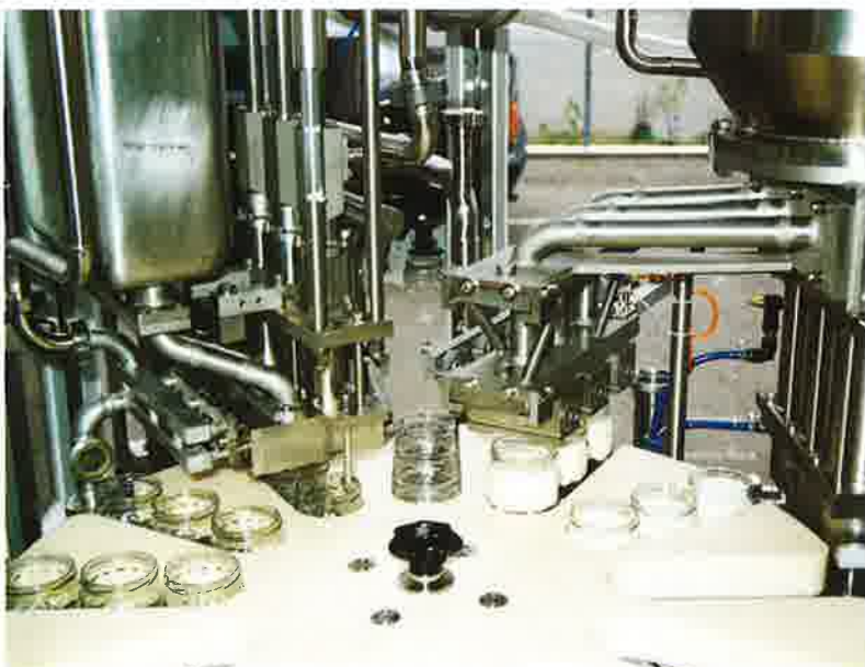
Vor- und Hauptdosierung in CIP-Ausführung
