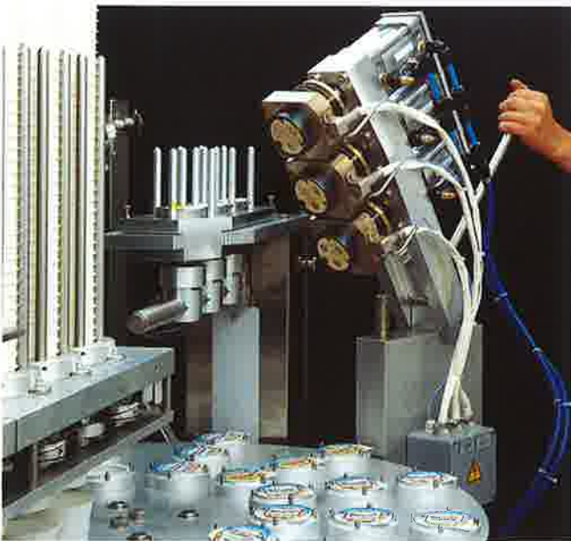
Heißsiegelstation in Reinigungsstellung
