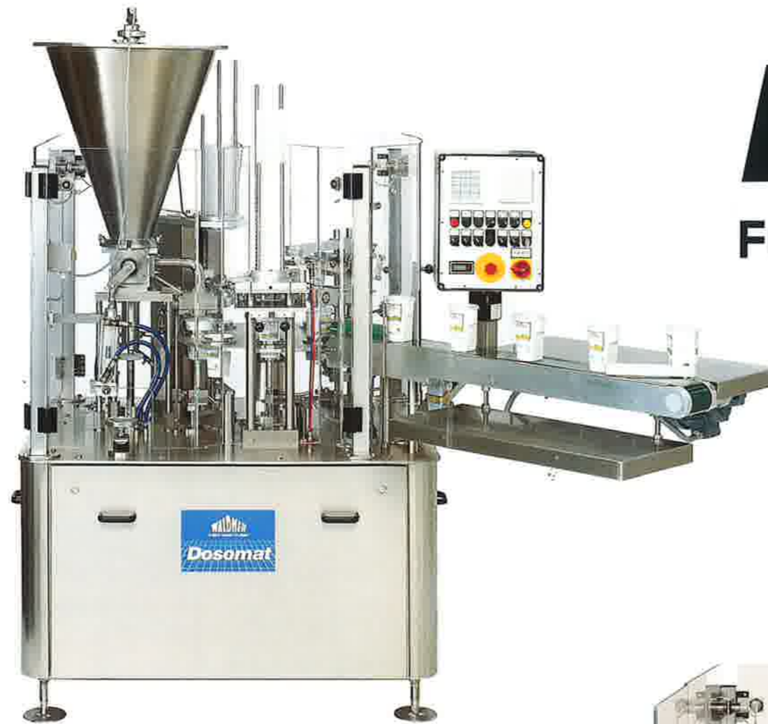
DOSOMAT ECO Rundläufer mit 1–2 Bahnen. Leistung: 2500–6000 Becher / Stunde
